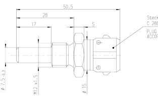
Steckeranschluß nach C 280 202 294 A PLUG CONNECTION ACCORDING TO C 280 202 294 A
